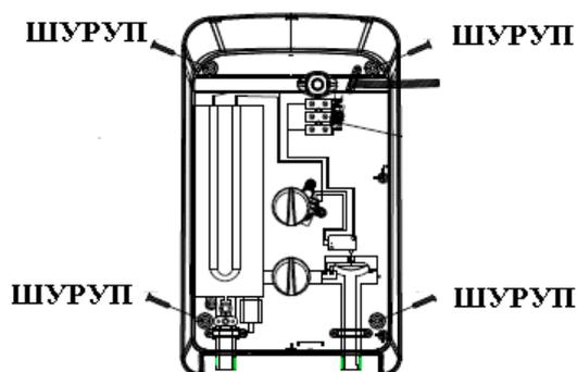
**Внимание! Конструкция стены должна выдерживать 4 массы водонагревателя, наполненного водой.**
